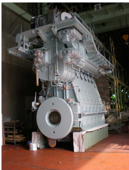
日立造船が設立した子会社4社が、1990年に合併したのがアイメックスだ。社名の由来は、IはInnoshima、MはMachinery、EはEngineering、Xは“限りない成長への可能性”を意味する。現在、事業はボイラー、ディーゼル機関、環境機械の3部門に分かれている。船用機器で生産している主力製品は、日立-MAN B&WのS/L35MC、S/L42MCなど2～3万総トン級船舶向けの船用ディーゼル機関で、国内の中小造船所に納入している。これまで450基以上を生産。大型ディーゼル機関で電子制御式の普及が進んでいるが、同社は今後、小型の2サイクル電子制御ディーゼル機関をライセンスとともに開発に取り組み、メニューを広げたい考え。
