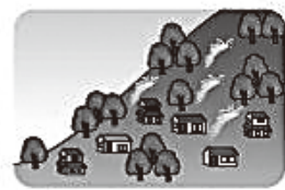
③斜面から水が噴き出す
