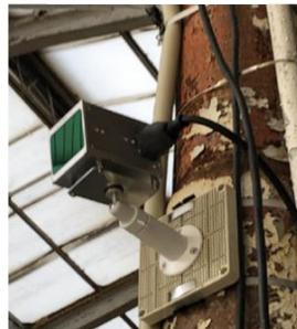
AIカメラ・LiDARに併設する小型コンピュータで映像解析を行い、人物の動線をデータ化し、クラウドで可視化や分析を行います。
