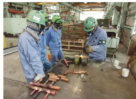
座学講義は、社団法人中小型造船工業会作成のテキスト及び映像教材を用いて行い、実技研修では、2班に分かれ、フランジとスリーブ継手を有するZ管の製作、L型の合わせ管の製作と取り付けを行うこととしております。
