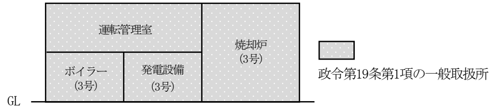
図1 建築物全体に政令第19条第1項の規定を適用した例
